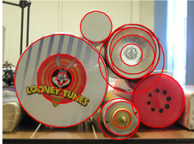
Εικόνα 74. Βέλτιστοι κύκλοι όπως προκύπτουν από τον μετασχηματισμό
