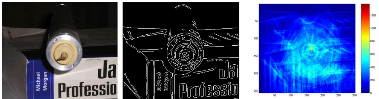
Εικόνα 72. Εικόνα, ανίχνευση ακμών και μετασχηματισμός Hough
